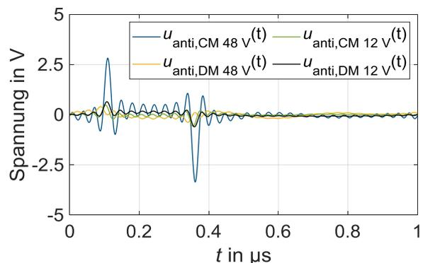
Abbildung 10: Gegenstörsignale für die Gleich- und Gegentaktinjektoren
