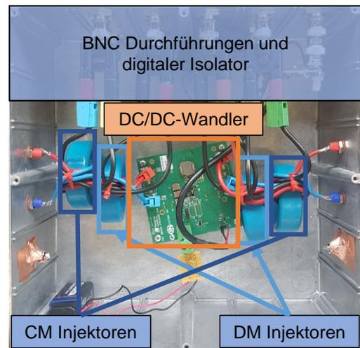
**Abbildung 8:** Foto des DUT mit Gleich- und Gegentaktinjektoren
