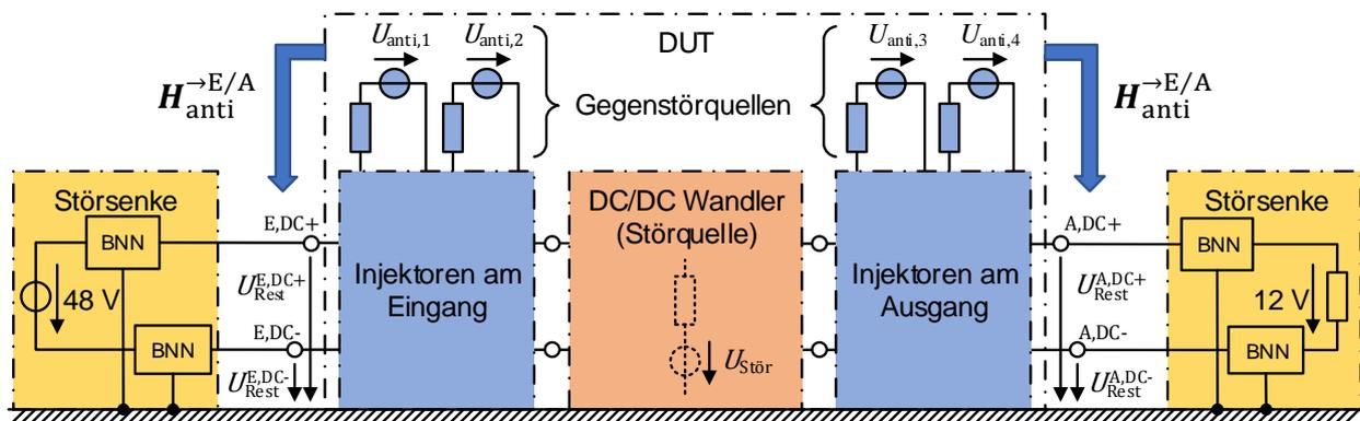
Abbildung 1: Schematische Darstellung des zu entstörenden Gesamtsystems
