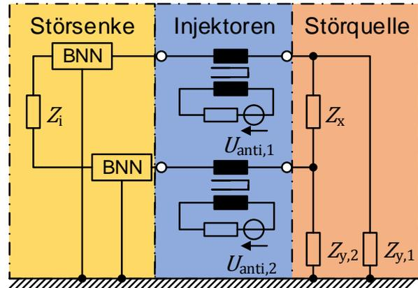
Abbildung 4: Induktives Injektorkonzept
