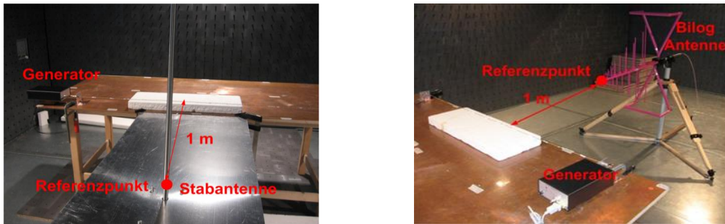
Abbildung 3: ALSE Testkonfiguration mit aktive Stabantenne (links) und Bilog Antenne (rechts)
