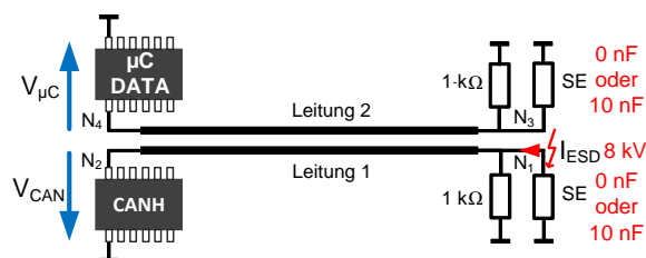
Abbildung 6: Simulationsaufbau mit Schutzelementen an beiden Leitungen
