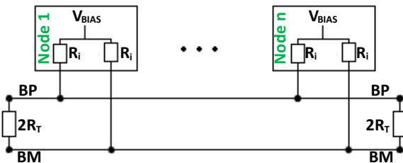
Bild 2 FlexRay-Netzwerk mit n Knoten und klassischem Netzabschluss
