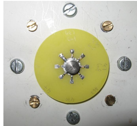
Abbildung 3: Stromtarget mit verschraubter Testplatine
