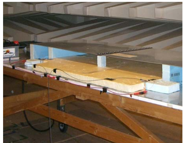
Abbildung 10: Laboraufbau eines LIN-Systems unter der Streifenleitung der EMC Test NRW GmbH in Dortmund
