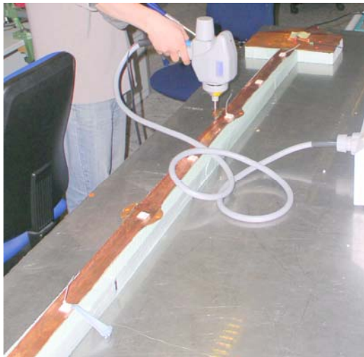
Bild 4 Prüfaufbau für Feldeinkopplung in eine Leitung oder ein Leitungsbündel über die A-Säule
