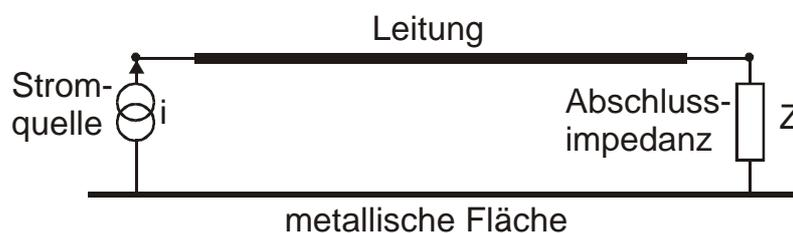
Abbildung 1: Testkonfiguration, eine Stromquelle speist über eine Leitung mit dem Radius 0,3 mm eine Abschlussimpedanz Z.
