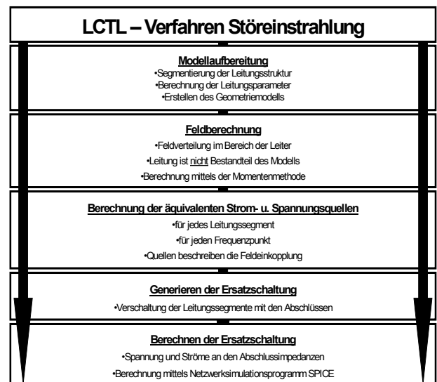
Bild 1 Berechnungsablauf beim LCTL-Verfahren
